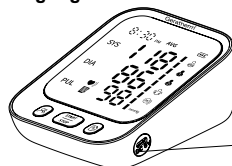
Anschluss für externe Stromversorgung
